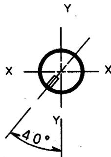
軸は反時計方向に回し切った状態を示す。
