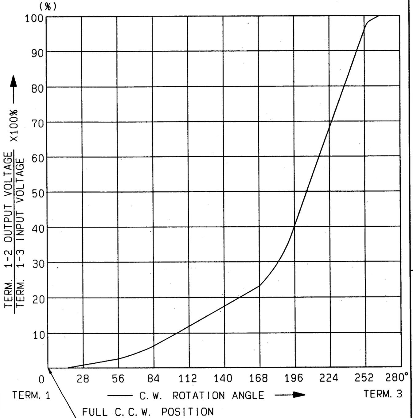
AT 140° C.W. SHAFT ROTATION FROM FULL C.C.W. POSITION VOLTAGE PERCENT SHALL FALL WITHIN THE LIMITS OF 10~25 PERCENT.
