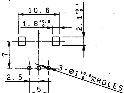
端子取付穴寸法図(挿入側より見た図)
