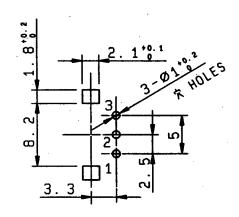
能子取付穴寸法図(挿入側より見た図) (許容差±0.1) MOUNTING HOLE DETAIL (TOLERANCE±0.1) VIWED FROM MOUNTING SIDE 板厚 t=1.6
