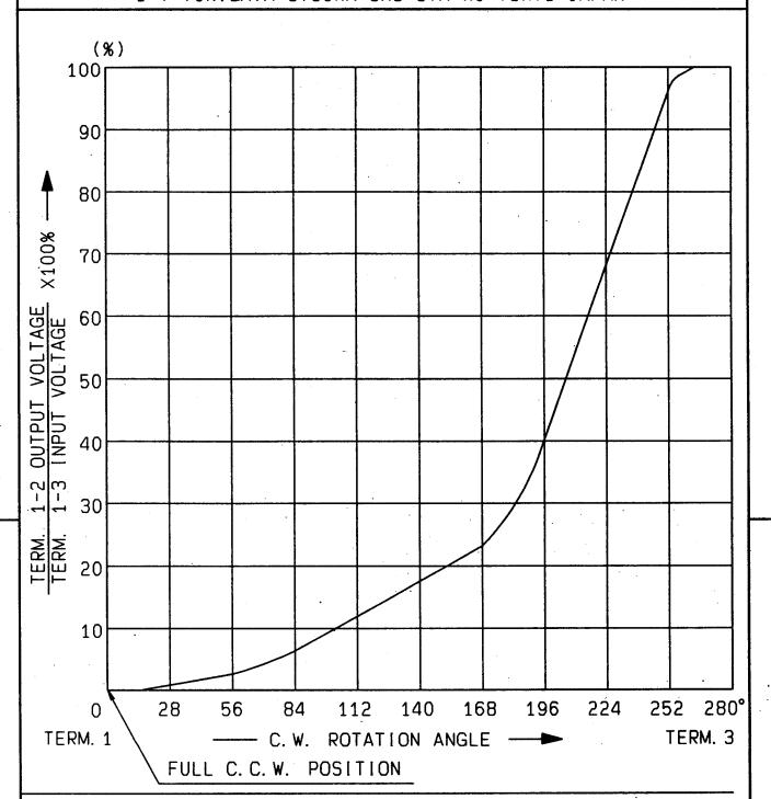
AT 140° C.W. SHAFT ROTATION FROM FULL C.C.W. POSITION VOLTAGE PERCENT SHALL FALL WITHIN THE LIMITS OF 10~25 PERCENT.
