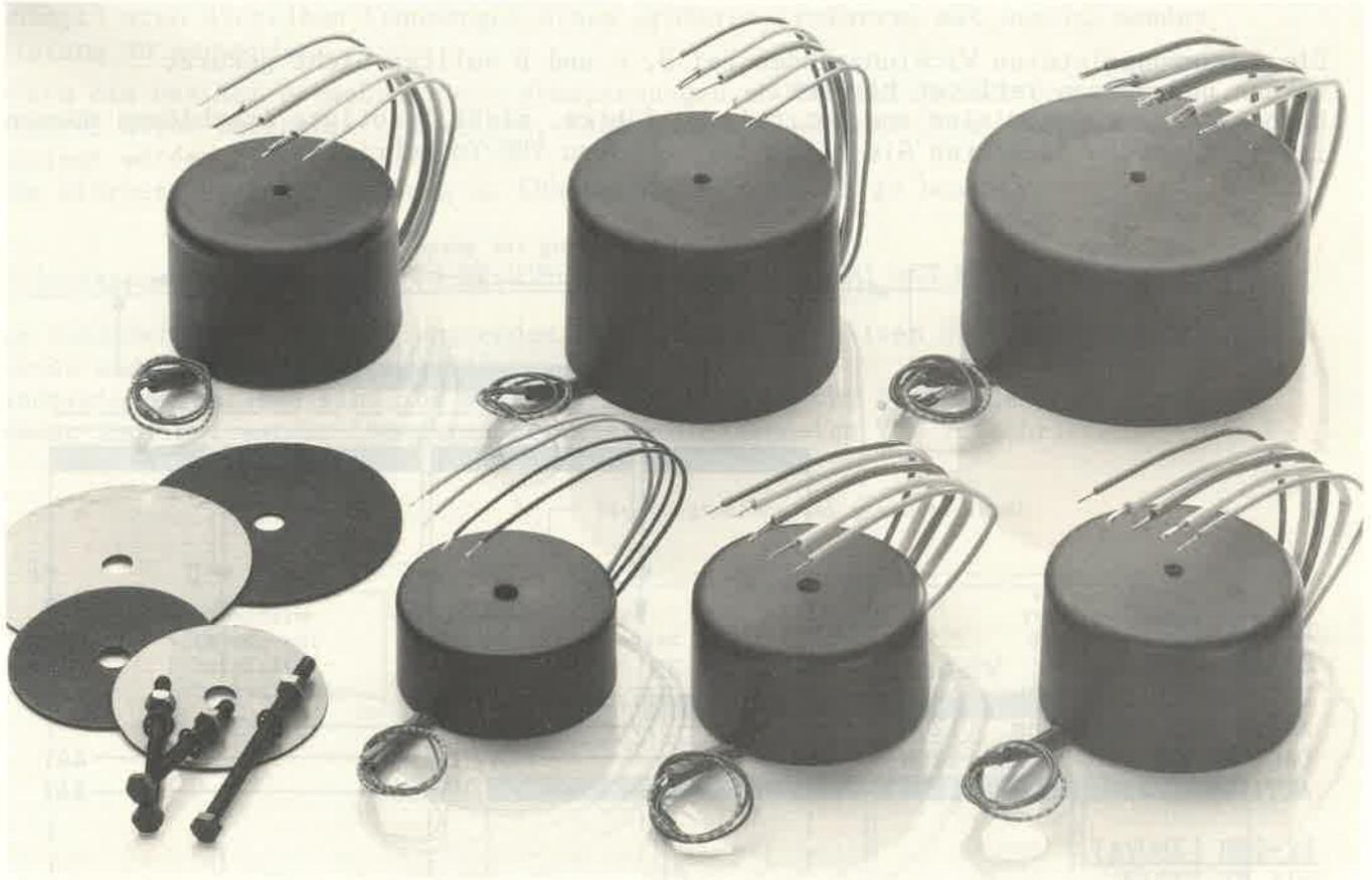
Unsere Ringkerntransformatoren werden nach einem speziellen Fertigungsverfahren hergestellt und entsprechen den VDE-Bestimmungen 0550. Die Prüfspannung zwischen Primär- und Sekundärwicklung beträgt 4kV, zwischen Primär- und Schutzwicklung 2,5kV.
